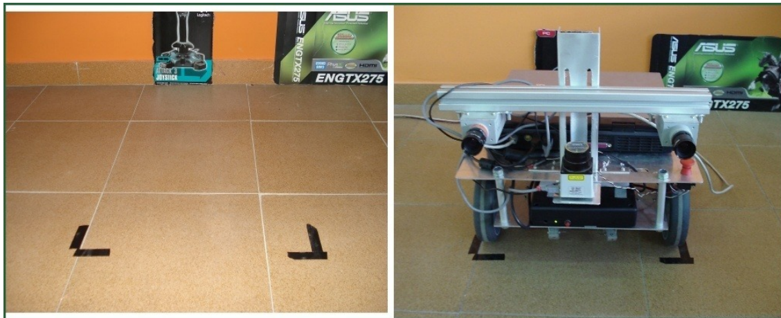
Figura 29: Marcas adhesivas ( izquierda ) y Robot situado en posición de inicio ( derecha )
